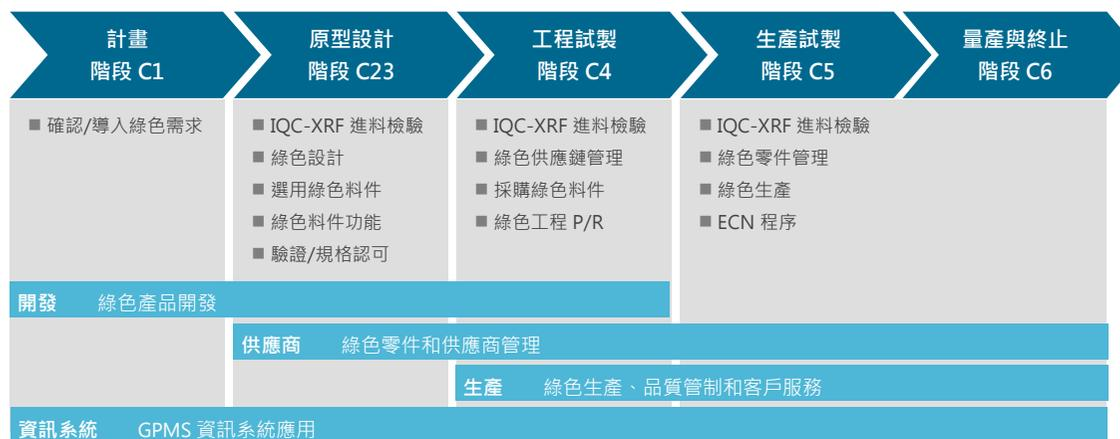
除了透過供應商源頭管理廠內材料及製程原物料，啟碁在廠內也使用精密的 XRF 進料檢驗儀器，對原物料及產品中具有對環境衝擊及有害的禁限用物質，進行確實而嚴謹的量測與監控。在無鉛製程與無鹵產品的趨勢下，啟碁依據客戶的要求，於 2006 年導入無鉛製程，並陸續將產品無鹵化規範導入產品物料與生產製程中，降低生產過程對環境的衝擊，並透過綠色採購與溝通，與供應商共同達成國際環保規範，致力於提供客戶省能源、無毒或低毒性、低汙染、可回收之設計與製造服務，以及對環境衝擊較低之綠色產品。2016 年，推動 IQC-XRF 檢驗作業流程優化作業，依原物料類別及綠色產品特性判斷是否符合 ROHS 2.0 豁免條件，作為放行依據。2017 年，接獲客戶綠色產品需求共 534 件，已於 2018 年第 1 季全數結案。
